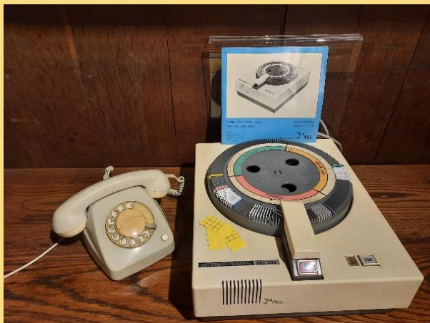
Der KKL 300, ein Kleinkartenleser der ersten Generation von SEL aus dem Jahr 1970 mit einem Karussellmagazin
